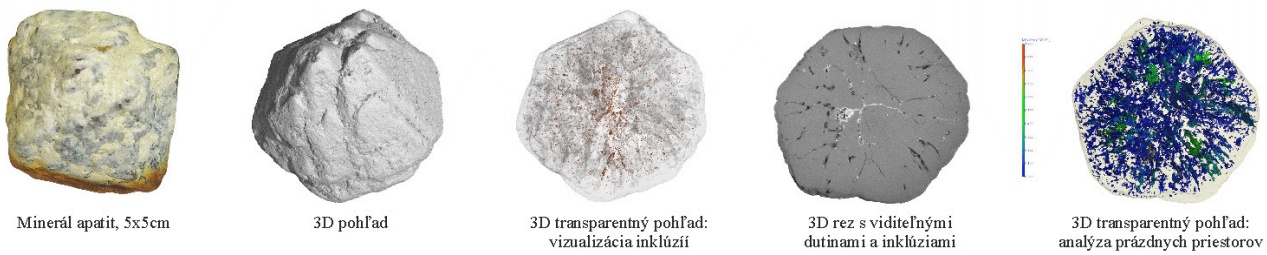
Obr. 11: Príklad využitia zariadenia mikro-CT: zrno apatitu, 3D pohľad, vizualizácia inklúzií, 3D rez a 3D transparentný pohľad.
